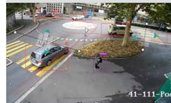
Saisie automatique du flux de circulation de tous les objets en mouvement sans enregistrement des données vidéo ou des images.
