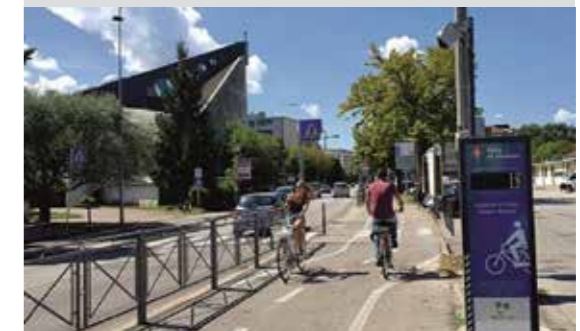
Un système de comptage de vélos typique composé d'un scanner laser et d'un écran à LED.
