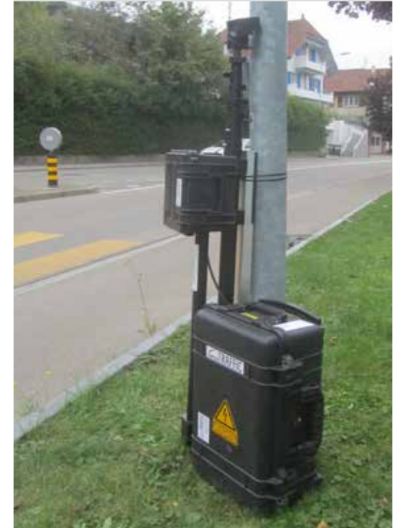
Système de caméra temporaire équipé d'un logiciel d'analyse avec AI pour les évaluations en temps réel et la représentation le tableau de bord approprié.
