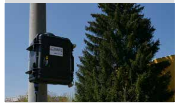
Le capteur hautement sensible détecte les bruits ambiants et analyse le profil du bruit via le logiciel d'apprentissage automatique intégré AI.
