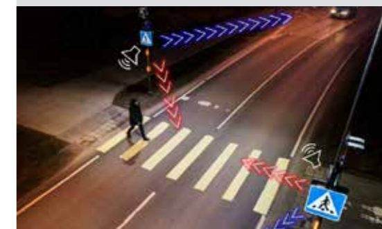
Détection automatique en temps réel des refus de priorité au niveau des passages pour piétons et avertissement des usagers de la route.
