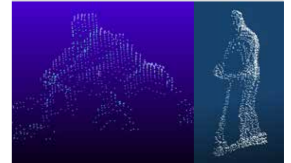
Eine Fahrrad- und eine e-Scooter-Punktwolke. Die Sensorsoftware kann zwischen Radfahrer, e-Scooter und Fussgänger unterscheiden.
