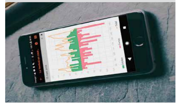
Automatische Übertragung der Zählraten über LTE oder SIGFOX. Anzeige der Zählerstände auf Android- oder iOS-Smartphones.
