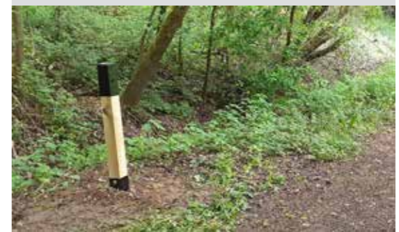
Installation am Rande eines Fussweges (1 Sensor integriert in einem Holzpfosten) möglich.
