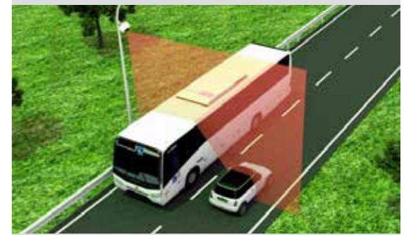
Bei einer Installationshöhe von ca. 8m können 2 Fahrspuren gleichzeitig abgedeckt werden.
