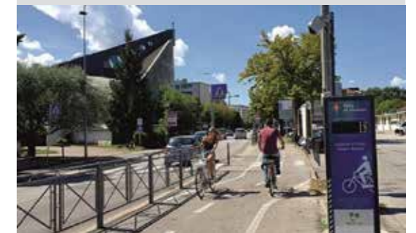
Ein typisches Fahrradzählsystem bestehend aus Laser-Scanner und LED-Display.
